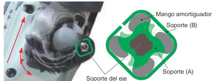
Reduce la vibración de la unidad principal por medio de cuatro mangos amortiguadores colocados alrededor del eje y soporte.
