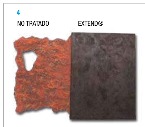
Resultado de una muestra tratada luego de 18 meses en un ambiente con elevada humedad relativa.
