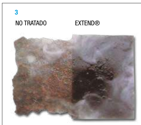
Resultado de una muestra tratada luego de un año en un ambiente con elevada humedad relativa.
