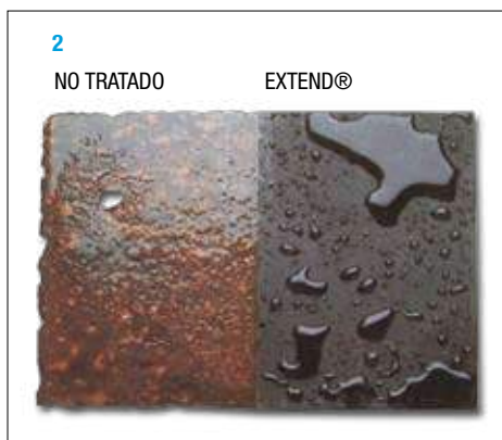
Resultado de un ensayo de 6 meses en niebla salina.
