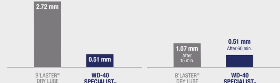
Prueba de desgaste de 4 bolas: Los resultados muestran el ancho de la marca después de 60 minutos a 12.000 RPM.
