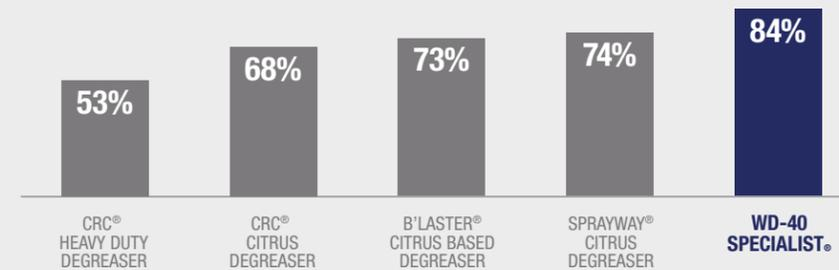
La prueba evalúa la capacidad de limpieza de un fluido usando un dispositivo mecánico. La puntuación muestra el porcentaje de la tierra eliminada. Laboratorio de prueba: Sterling Laboratories (Toledo, OH); ASTM D4488-A3; Sprayway es una marca registrada de PLZ Aeroscience Corporation; B'laster es una marca registrada de B'laster Chemical Company Inc.; CRC es una marca registrada de CRC Industries, Inc. Probado 05/2020.
