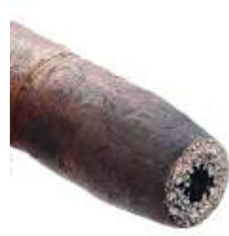
Boquilla totalmente obstruida (que no utiliza E-WELD Nozzle)
